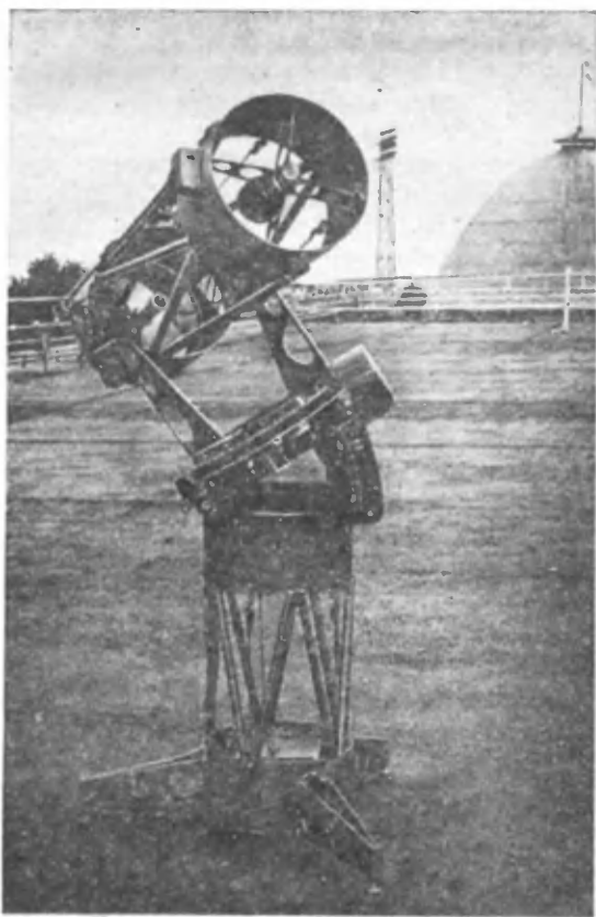
Рис. 155. Самодельный рефлектор УПТР-10 на вилочной установке (А. Н. Подъяпольского) с использованием каркасных конструкций.
