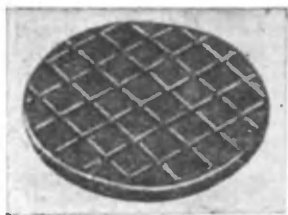
Рис. 141. Металло-стеклянный шлифовальник для обработки плоского зеркала.
